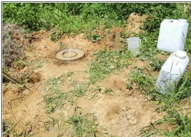
图 5.2-8 地下水渗透实验图
